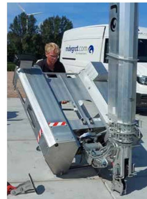
onder: Op de speciale mastenwagen kunnen masten tot 18 meter over de weg worden vervoerd
